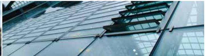
Ventelles de façade (DENFC à lames), pour l'aération et le désenfumage naturel en façade - Certifié CE selon la norme EN 12101-2. Profilés en aluminium à rupture de pont thermique anodisé ou teinte RAL au choix, finition de grande qualité. Remplissages en verre double ou triple vitrage, manœuvre électrique 24VCC avec moteur invisible breveté.
