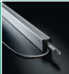
Large gamme de vérins linéaires 24VCC ou 230VAC, pour adaptation sur tout type d'ouvrants d'aération ou de désenfumage, avec des forces de 200N à 2000N. Un moteur spécial permet d'équiper les jalousies en 24VCC pour l'aération.
