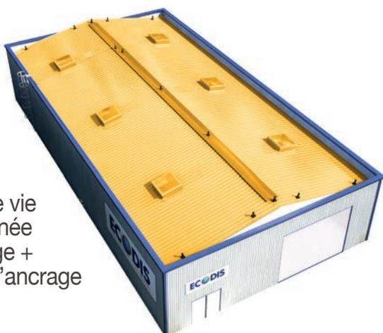
Ligne de vie positionnée au faîtage + points d'ancrage
